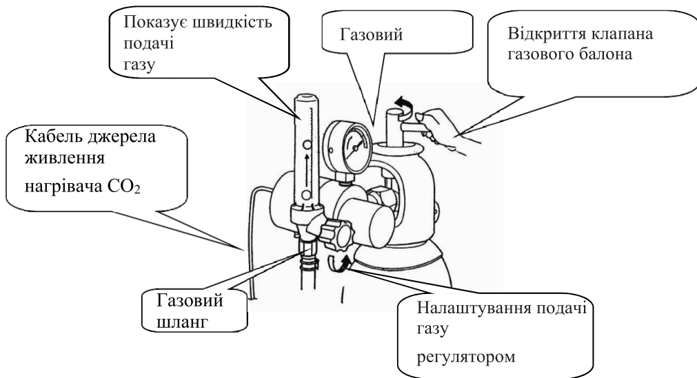
Малюнок 4: Відкриття газового клапана й налаштування подачі газу (для зварювання MAG у середовищі CO 2 )
