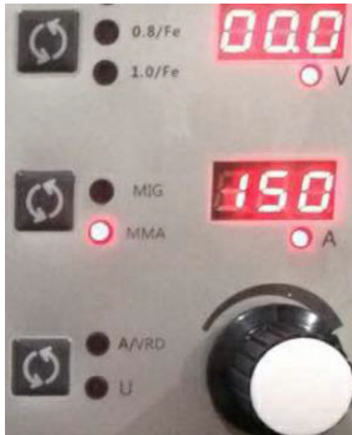
Малюнок 9: Зварювання MMA без функції VRD (світлодіод «A/VRD» не горить)
