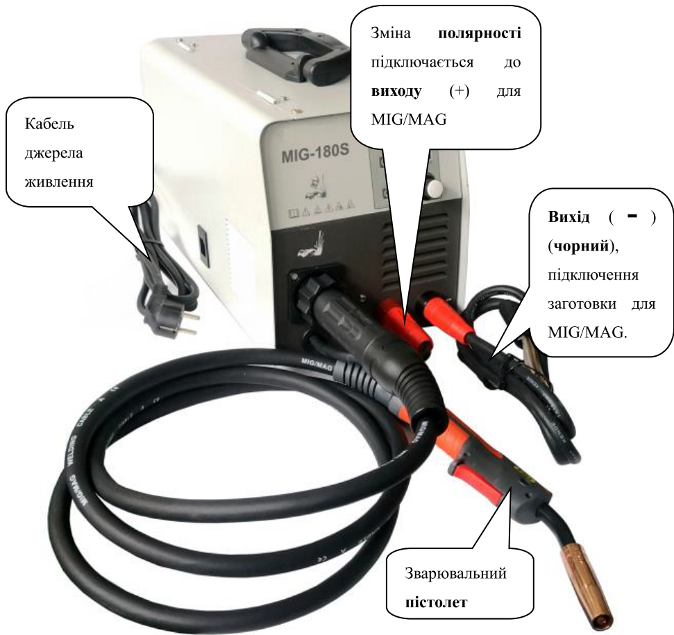
Малюнок 6: Підключення для зварювання MIG/MAG
