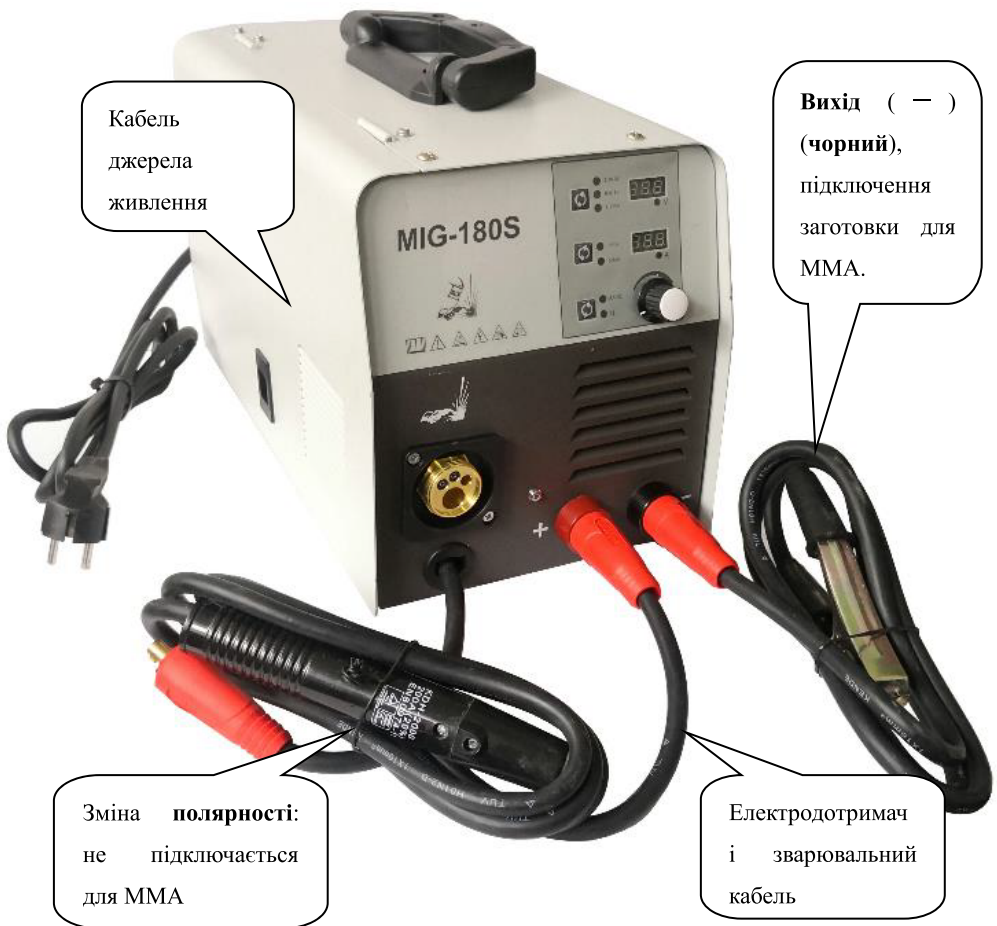
Малюнок 7: Підключення для зварювання ММА
