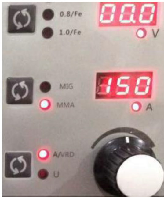
Малюнок 10: Зварювання MMA з функцією VRD (світлодіод «A/VRD» горить)
